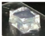
つる巻き重合法により構築されたアミロースベースの超分子ヒドロゲル
