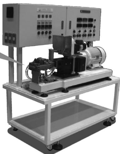
多軸押出機における初期基礎データ収集を目的として開発されたULTnanoは、2軸押出機への機種拡張も容易に可能なフレキシブルな装置です。
