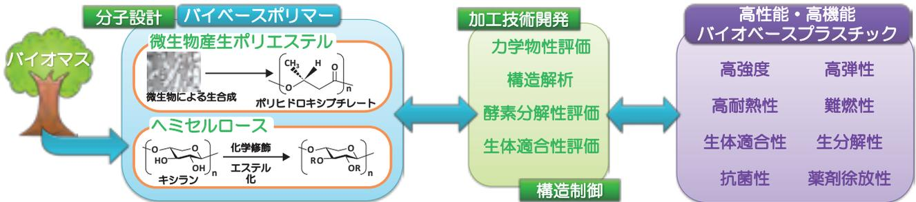
私たちは、石油原料ではなく糖や植物油などのバイオマスからつくられる「バイオベースプラスチック」と、使用中は従来のプラスチックと同じ性能を発揮し、使用後は環境中で分解する「生分解性プラスチック」に関する研究を行っています。化学合成、生物合成、物性評価、構造解析、酵素分解など、高分子の化学・材料学・構造学・環境化学の幅広い観点から、環境にやさしいプラスチックの基礎から応用まで様々な研究開発を行っています。
