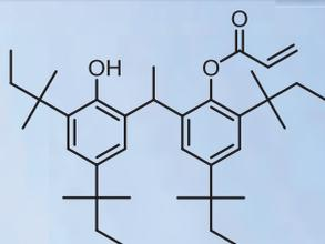
耐着色性に優れ、ブタジエン系ポリマー、スチレン系ポリマーおよびポリオレフィンなどのラジカル捕捉剤として使用されます。特に押出成形、射出成形時の加工中の劣化による架橋を防止する効果に優れます。
