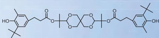
耐蒸散性、耐着色性に優れた酸化防止剤で、ポリオレフィン、スチレン系樹脂、ポリウレタン弾性繊維、エンジニアリング・プラスチック等の分野で使用されます。有機イオウ系二次酸化防止剤との併用で優れた相乗効果が得られます。
