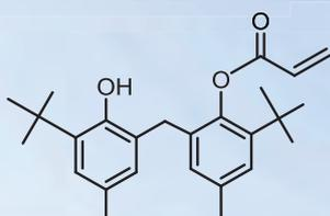
ブタジエン系ポリマーのラジカル捕捉剤として使用されます。特に加工中の熱劣化による架橋を防止する効果に優れます。
