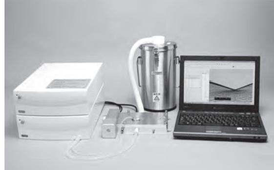
このステージは、顕微鏡下の試料を加熱・冷却した状態で延伸(引張)による変化・伸び・破断をリアルタイムで観察できます。(室温での延伸(引張)測定も可能です。)
