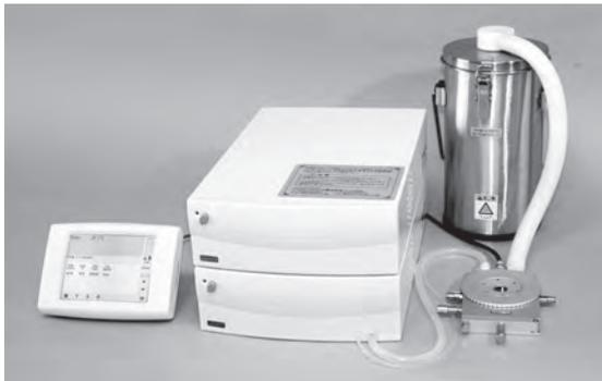
このステージは、顕微鏡下の試料の温度を自由に制御することができます。物質の熱変成の研究、品質管理等に使用できます。温度範囲が広く、設定温度に対してオーバーシュートしません。操作が簡単で高再現性です。
