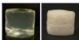
TEMPO酸化セルロースナノファイバー由来のヒドロゲル(左)およびエアロゲルの組織構造に由来するバルーン膨潤状態
