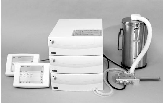
このステージは、顕微鏡下の試料を温度制御し、20000°C/minの速度でジャンプ(急冷)することができ、その挙動を観察できます。
