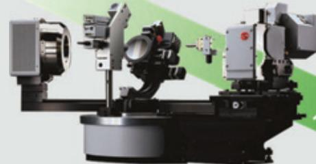
多機能材料評価X線回折装置
